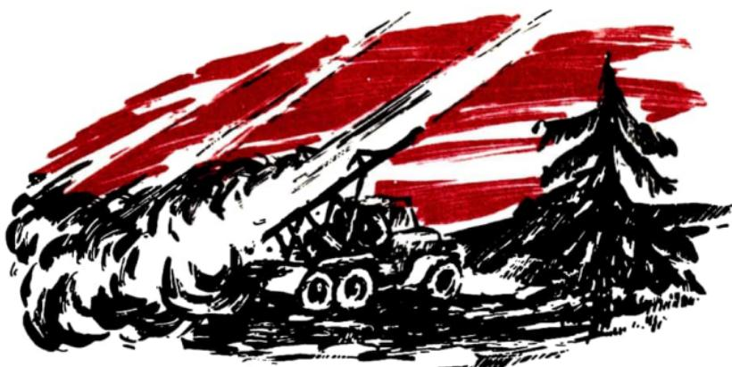
Raketenwaffe des zweiten Weltkrieges. Vor Moskau, an der Wolga und auf dem Weg bis Berlin donnerte ihr orkanartiges Feuer. Die Raketenwerfer, die meist auf Lastkraftwagen montiert wurden, schossen sechzehn oder achtzehn Projektiler pro Salve ab. Von einer Einheit konnten so tausend Raketen mit einem Schlag abgefeuert werden.
