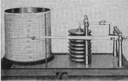
Abb. 1.4. Der Barograph zeichnet Schwankungen des Luftdrucks auf einer durch ein Uhrwerk bewegten Trommel auf
