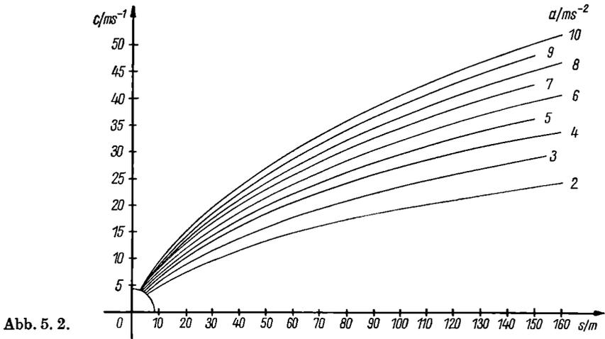
Jede Kurve gilt für eine bestimmte Verzögerung  $a$ , die deshalb an die jeweilige Kurve geschrieben werden muß. Man erhält ein Diagramm mit einer Kurvenschar. Der jeweils zugeordnete Zahlenwert von  $a$  (in  $ms^{-2}$ ) heißt der Parameter der betreffenden Kurve. Das Diagramm ist also die graphische Darstellung der Funktion
