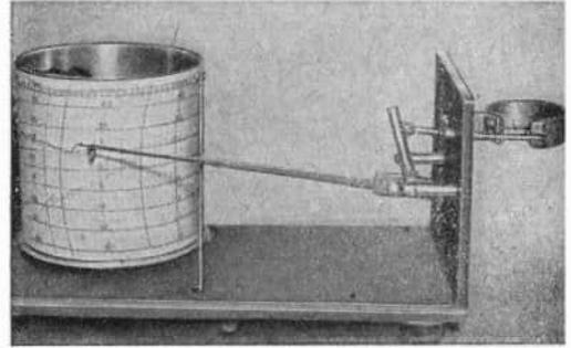
Abb. 1.5. Der Thermograph zeichnet Schwankungen der Lufttemperatur auf einer durch ein Uhrwerk bewegten Trommel auf
