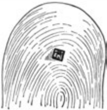
Bild 44. Monolithschaltelement im Größenvergleich mit einer Fingerkuppe
