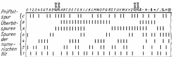
Bild 68. Schematische Darstellung der Magnetfelder zur Zeichen- und Überbitdarstellung auf einem Magnetband
