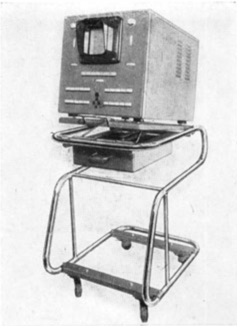
Bild 116. Oszillograf als Kontrollgerät für den „endim 2000“
