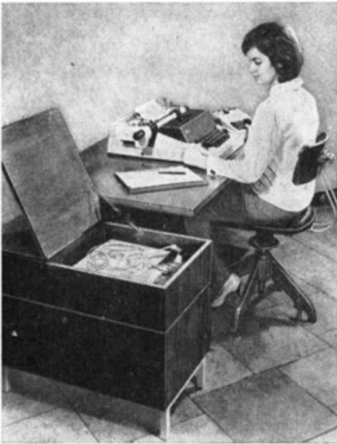
Bild 131. Elektronischer Fakturierautomat mit Lochstreifen-einrichtung Soemtron 381/41
