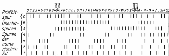
Bild 68. Schematische Darstellung der Magnetfelder zur Zeichendarstellung auf einem Magnetband
