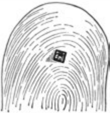
Bild 44. Monolithschaltelement im Größenvergleich mit einer Fingerkuppe
