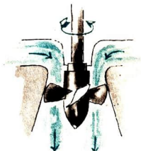
Laufrad einer Kaplan turbine
