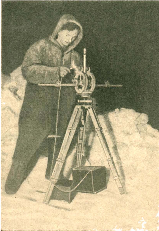
Der Hydrograph einer Arktisexpedition bei Beobachtungen an dem Magnetapparat im Grönlandmeer.
