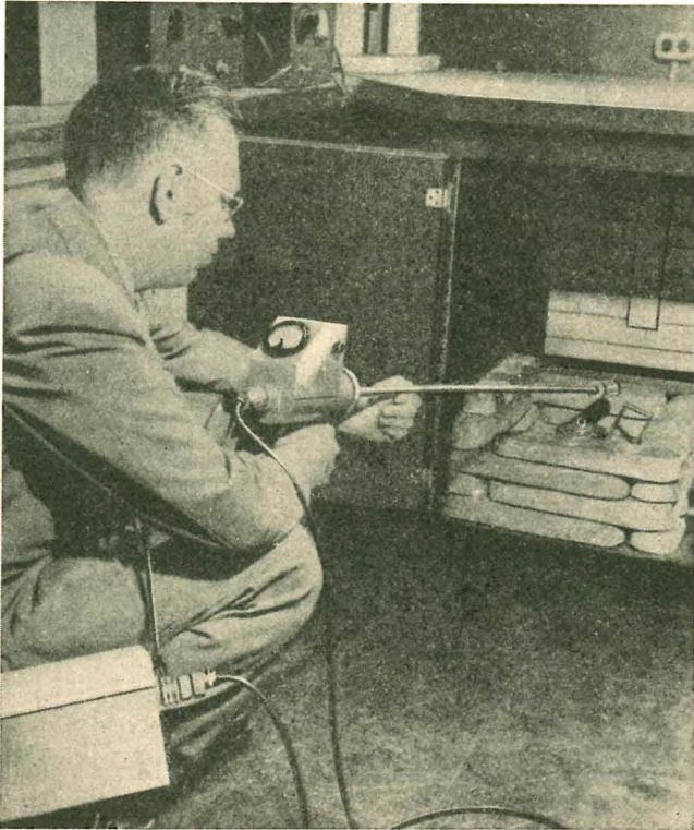
Dicke Bleiplatten verhindern eine Ausstrahlung der Radioisotope. Mit einem Geiger-Müller-Zählrohr wird überprüft, ob der Strahlungsschutz ausreichend ist
