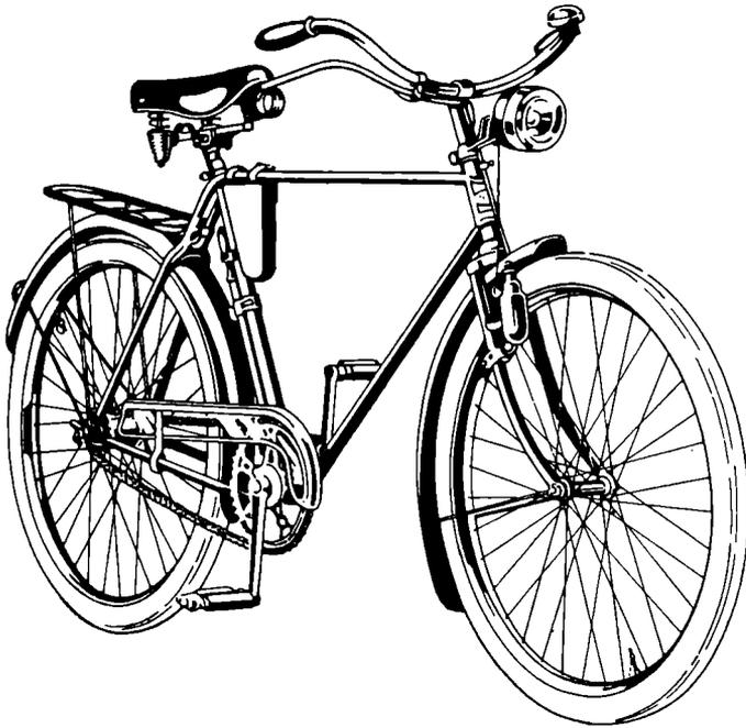
Beginnen wir mit dem wichtigsten Teil des Fahrrades, dem *Rahmen*. Man unterscheidet Rahmen für Herrenräder und Rahmen für Damenräder. Mit Rücksicht auf die Kleidung der Frau ist beim Damenrahmen die obere Querstange weggelassen. Um die Stabilität zu gewährleisten, ist zusätzlich ein gebogenes Rohr, vom Sattelstützrohr zum Steuerrohr führend, angebracht. Als Material wird im allgemeinen Stahlrohr von 25 bis 28 mm und 1 bis 1½ mm Wanddicke verwendet.
