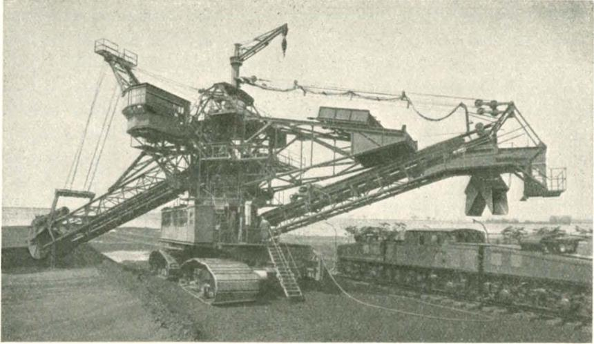
Schaufelradbagger mit Raupen bei der Mutterbodengewinnung
