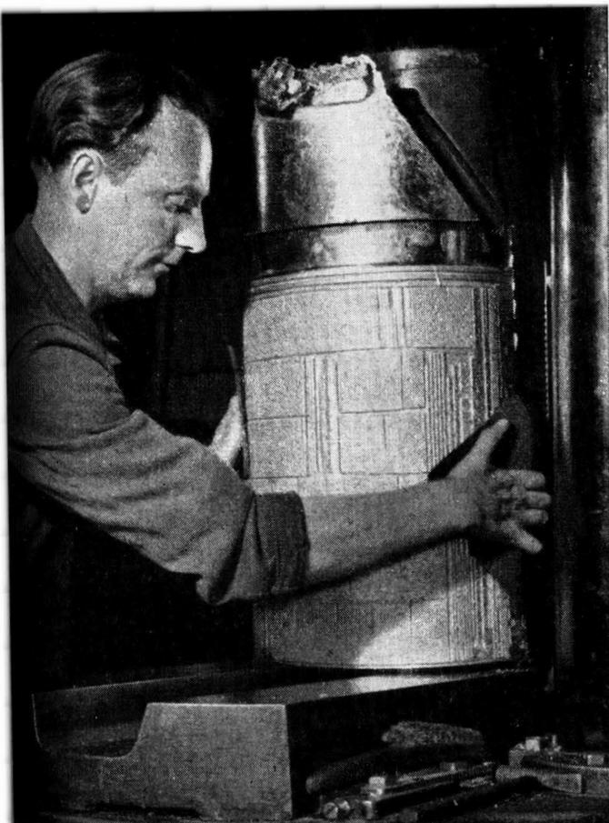
Mit diesen „Rundstereos“, die auf die Walzen der Rotationsmaschine gespannt werden, wird unsere Zeitung gedruckt. Der Stereotypour ist gerade dabei, sie auf einer Maschine auf das genaue Maß zu bringen.
