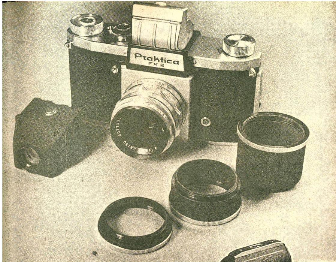
erfassen. Das Mattscheibenbild ist ursprünglich seitenverkehrt und bei Aufnahmen im Hochformat sogar kopfstehend. Durch ein Dachkantprisma, das an Stelle des Lichtschachtes in die Kamera eingesetzt oder auf den Lichtschacht aufgesetzt werden kann, wird es aber so ins Auge gespiegelt, daß es bei Quer- und Hochaufnahmen stets seitenrichtig und aufrechtstehend ist.
