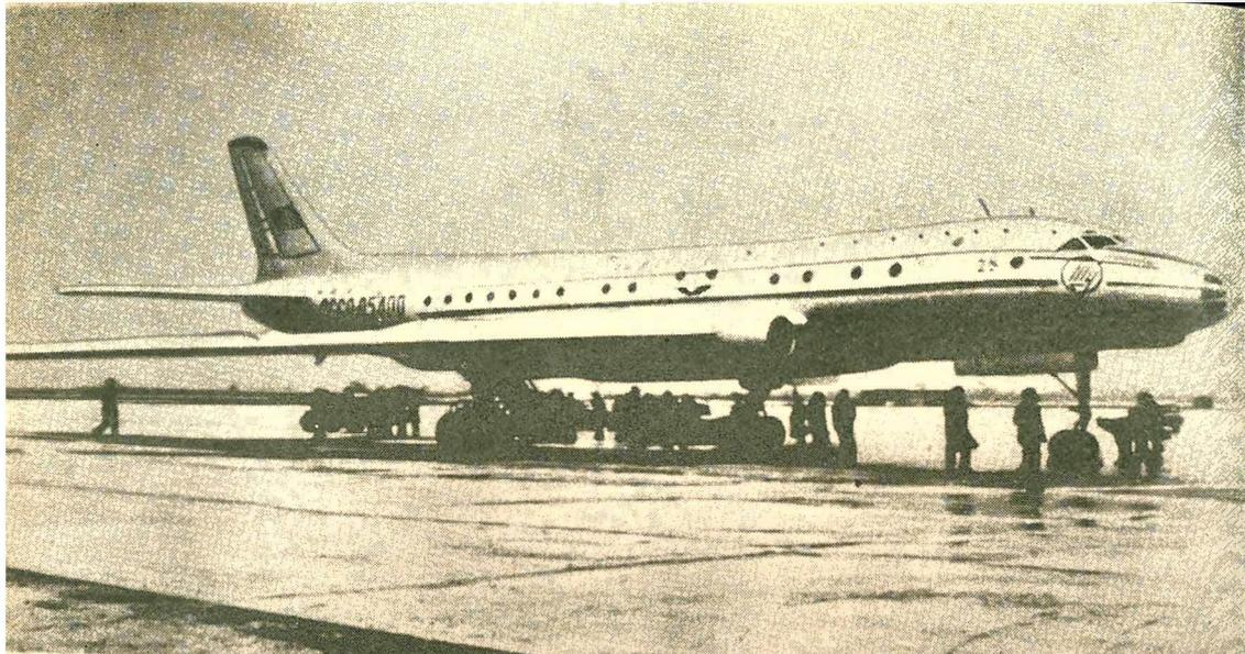
*Sowjetisches Düsen-Passagierflugzeug „TU“ 104. Es wird von vier Düsenaggregaten angetrieben und erreicht eine Geschwindigkeit von 900 km/h*
