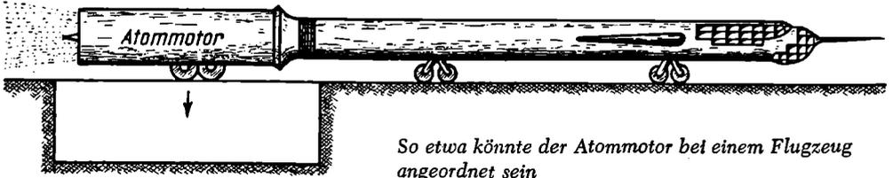
Bei größeren Abmessungen ist der Strahlenschutz weniger schwierig. Seine notwendige Dicke ist nämlich nicht direkt von der Leistung des Reaktors abhängig. Wenn zum Beispiel ein 60 Zentimeter dicker Schirm die Strahlung eines Reaktors auf ein erträgliches Maß herabmindert, so braucht man für einen zehnmal stärker-
