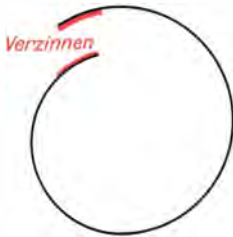
Bild 83. Vorbereitung der Lötnaht
