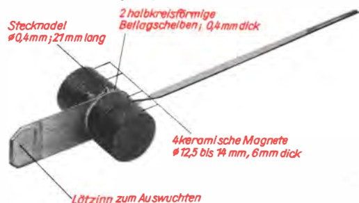
Bild 116. Drehmagnetsystem
