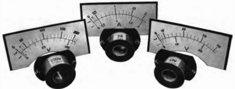
Bild 130. Skalen und Spulen des Dreheisenmeßgerätes
