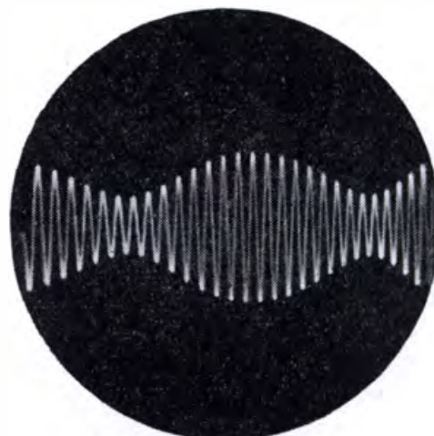
Bild 11.18 Oszillogramm einer mit 50 Hz modulierten Schwingung im „Empfänger“
