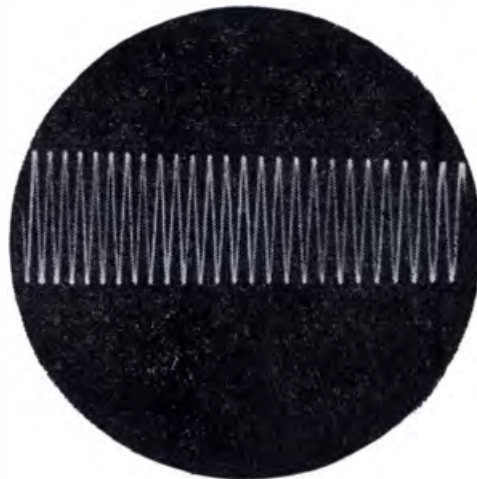
Bild 11.8 Oszillogramm einer ungedämpften Schwingung des Ton- generators
