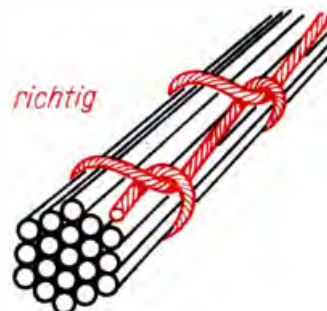
Bild 3.17 So wird ein Kabelbaum abgebunden
