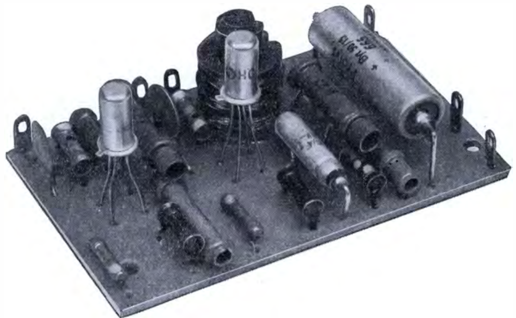
Bild 18.10 So sieht die bestückte Leiterplatte des Zweikreisempfängers aus
