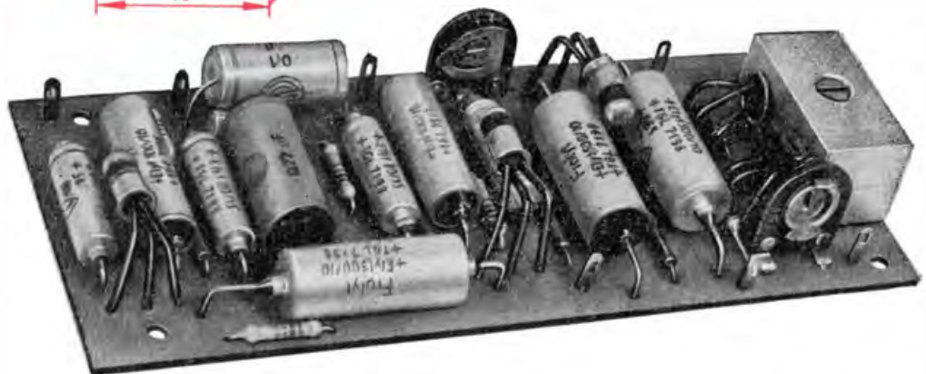
Bild 18.27 So sieht die bestückte Leiterplatte des Gegentaktverstärkers mit eisen- loser Endstufe aus
