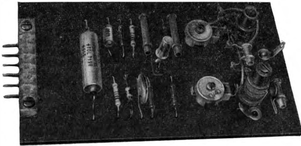
Bild 13.9 Unser zweiter Bau- stein: Der Einkreiser, von der Bauelemen- tenseite (a) und von der Verdrahtungsseite (b) gesehen
