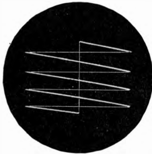
Bild 19.7 Oszillogramm eines Rasters mit 4 Zeilen
