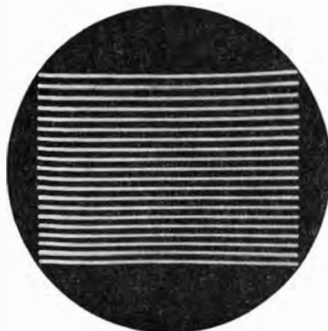
Bild 19.8 Oszillogramm eines Rasters mit 20 Zeilen
