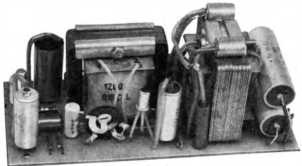
Bild 18.5 So sieht die bestückte Leiterplatte des Gegentaktver- stärkers aus
