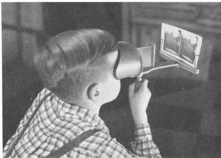
Stereoskop zum Betrachten von Stereoaufnahmen
