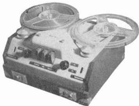
Das Magnetongerät dient zum Aufnehmen und Abspielen von Musik und Sprache. Von der einen Spule rollt das Tonband ab, auf die andere wird es wieder aufgewickelt.
