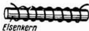
Ein Elektromagnet besteht aus einer Spule aus isoliertem Leiterdraht, die auf einen Eisenkern gewickelt ist.
