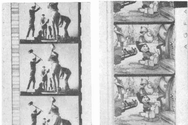
Ausschnitte aus Tonfilmstreifen. Links neben den Filmbildern ist der Ton entweder in Sprossenschrift oder in Zackschrift aufgezeichnet.
