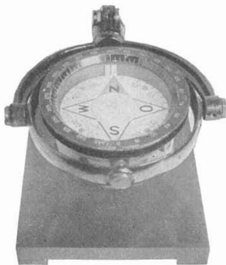
Ein Schiffskompaß wird kardanisch aufgehängt. Die Kompaßrose bleibt immer waagrecht, auch wenn das Schiff bei stürmischer See stark schwankt.
