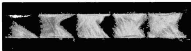
Fotografie einer Funkenentladung. Sie zeigt uns, daß viele Teilfunken in wechselnder Richtung die Funkenstrecke überbrücken
