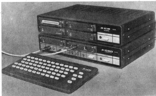
Abb. 1.2/2b: KC 85/3 des Kombinates Mikroelektronik (VEB Mikroelektronik „Wilhelm Pieck“, Mühlhausen)
