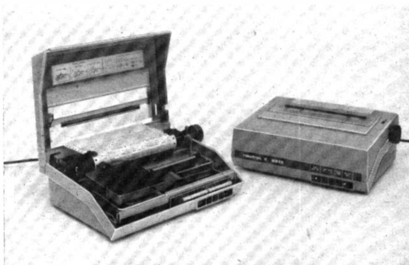
Abbildung 1.14 Matrixdrucker K 6313 in der Ausführung „Schreibwalze mit Stachelsystem und Handrad“
