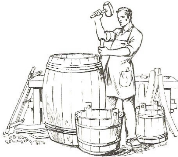
Abb. 106 Die Reifen umspannen die Dauben fest, wenn sie auf den breiteren Umfang des Fasses getrieben werden
