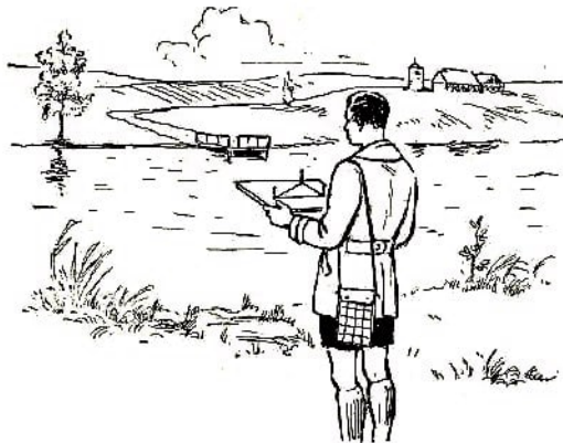
Abb. 25 Die Flussbreite wird mit dem Stecknadelgerät ermittelt
