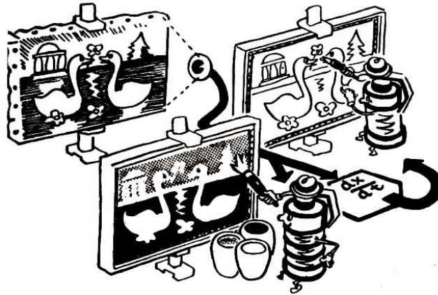
Bild 6.14.: Die Umwandlung eines Bildes mit Farb- und Sättigungswerten in eine Konturendarstellung kann durch ein nichtlineares Glied, einen Differentiator, erfolgen.
