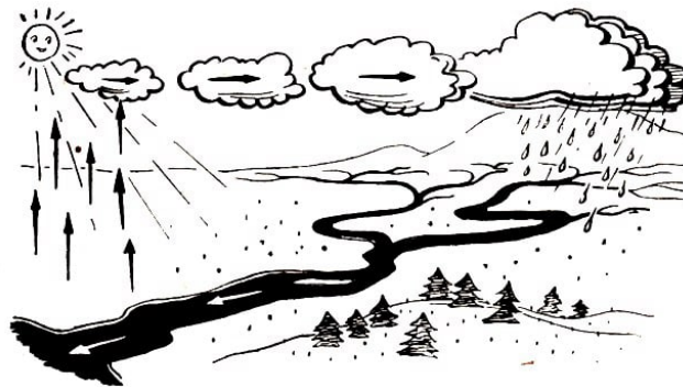
Bild 5.3.: Ein idealisierter Fluss, bei dem das Wasser nur im Unterlauf verdunstet und nur im Quellgebiet als Regen fällt, ist ein Beispiel für ein System mit verzögerter Rückwirkung.
