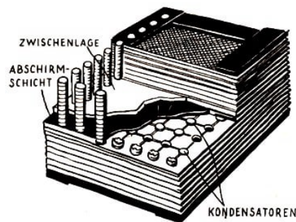
Bild 13.4.: Der Festwertspeicher DESU (langfristige kapazitive Gedächtniseinrichtung) ist einfach ein Paket von zusammengehefteten Blättern mit Zwischenlagen und Abschirmschichten. Auf jedes Blatt ist ein Netz von Kondensatoren gedruckt. Beim Einspeichern werden, entsprechend dem Kodewort, das aufbewahrt werden soll, Kondensatoren aus dem Blatt herausgeschnitten.
