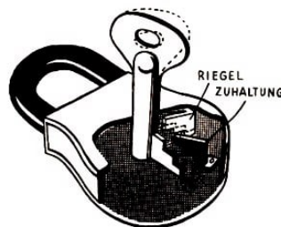
Bild 12.1.: Ein Schloss führt eine logische Operation aus: Es vergleicht das im Schlüssel enthaltene Kodewort mit dem durch die Zuhaltung realisierten Kodewort.
