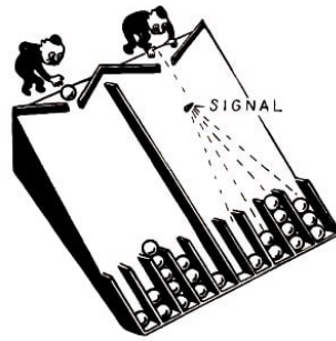
Bild 3.2.: Kugeln, die in diese Vorrichtung eingeworfen werden, verteilen sich im linken Teil der Vorrichtung entsprechend dem Gesetz der großen Zahlen. Im rechten Teil der Vorrichtung dient eine kleine Erhöhung als Signal; dieses Signal verändert die Verteilung der Kugeln auf die Fächer.
