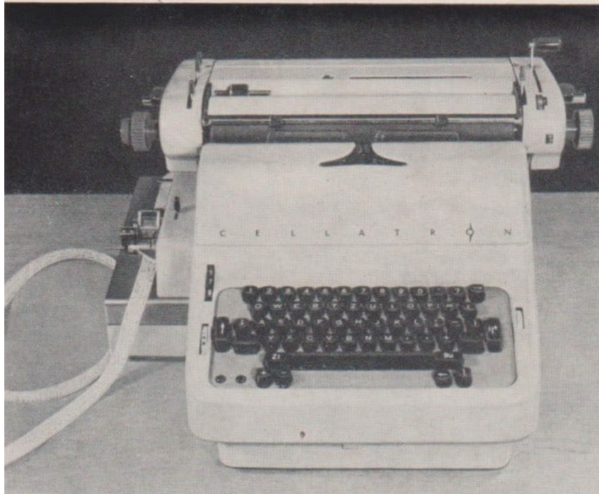
Elektrische Schreibmaschine mit angebautem Lochbandlocher (Cellatron - VEB Kombinat Zentronik, Betrieb Rechenelektronik Meiningen/Zella-Mehlis)
