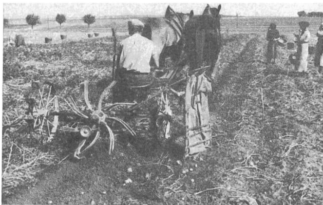
Schleuderradroder bei der Kartoffelernte
