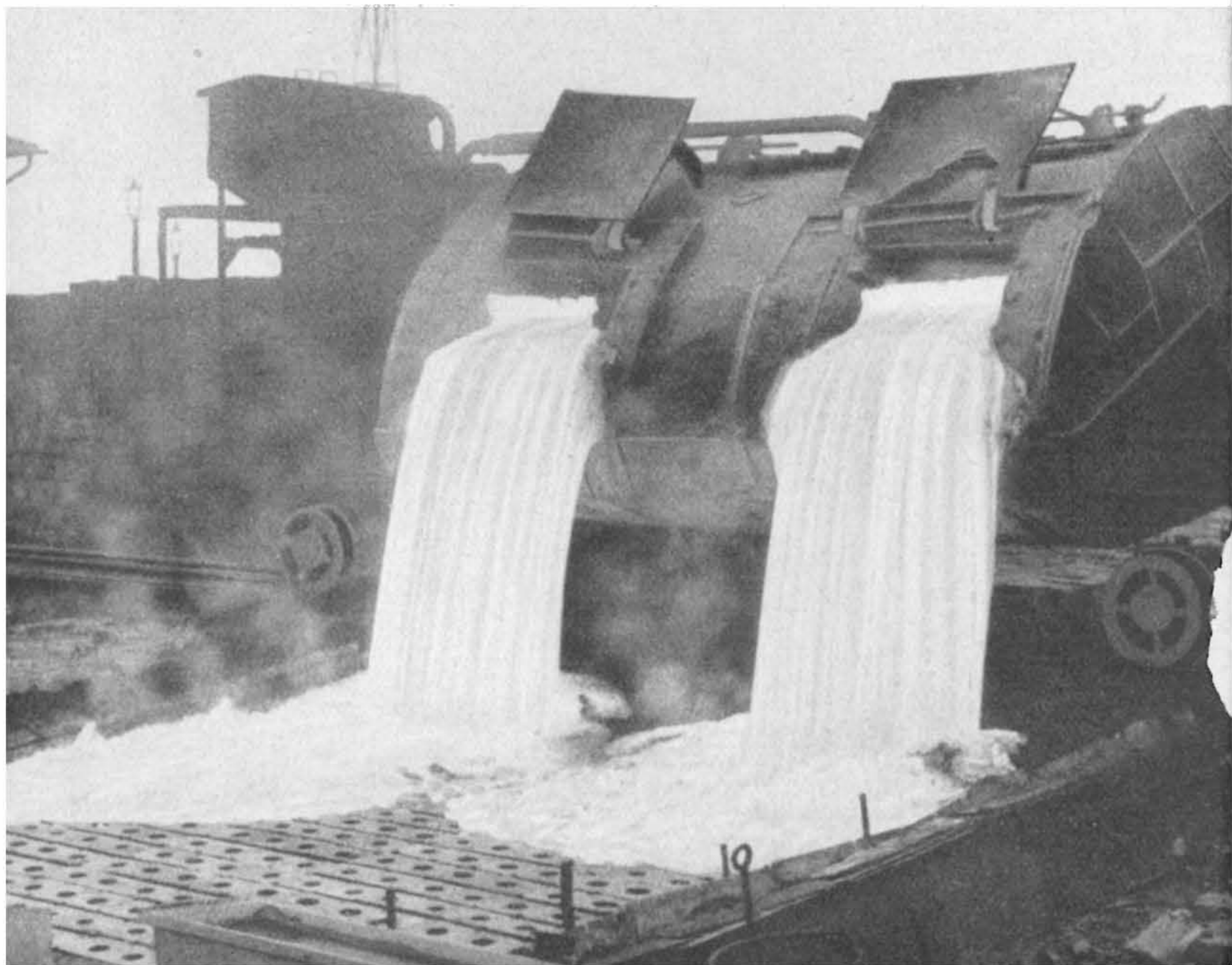
Bild 17 Gießen von Schlackenpflastersteinen. Schlackenwagen bringen die flüssige Schlacke heran.
