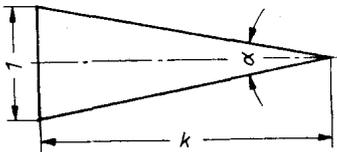
„Kegel  $1:k$ “ bedeutet: Auf die Länge  $k \text{ (mm)}$  verjüngt sich der Kegel im Durchmesser um  $1 \text{ (mm)}$ .
