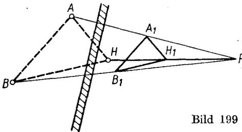
Punkt H und einen weiter zurückliegenden Punkt P. Man mißt die Winkel AHP und PHB. Man trägt sie an einen auf HP gelegenen beliebigen Punkt H<sub>1</sub> an und erhält die Punkte A<sub>1</sub> und B<sub>1</sub>. Es ist dann
