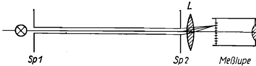
Abb. 161. Wellenlängenmessung durch Beugung am Spalt bzw. Doppelspalt
