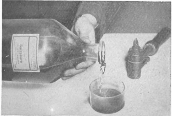
Abb. 31. Aus Zink und roher Salzsäure wird Lötwater hergestellt.
