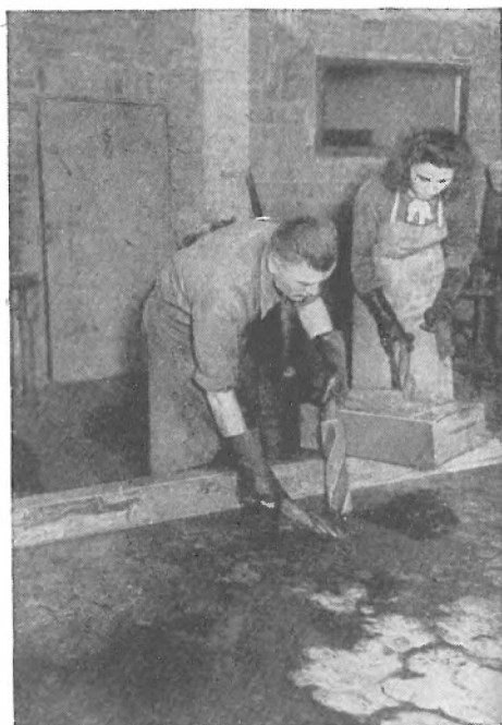
Abb. 100. Stahlteile werden durch „Beizen“ mit Säure entrostet.
