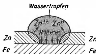
Abb. 43. Elektrolytische Korrosion von verzinktem Eisenblech. Die Zinkschicht wird aufgelöst.
