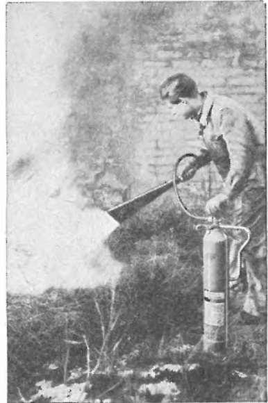
Abb. 19. Löschen eines Ölbrandes mittels Kohlendioxid-Löcher
