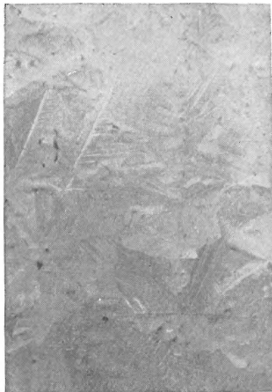
Abb. 92. Auf verzinkten Geräten ist die Kristallstruktur des Zinküberzuges deutlich zu erkennen.
