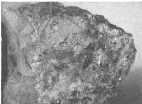
Abb. 55. Hochofenschlacke. Sie fällt als Nebenprodukt bei der Roheisengewinnung an.
