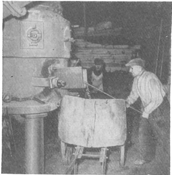
Abb. 69. Der Brigadeleiter und Aktivist der Gießerei der Halle-Saale-Werke, Hermann Stern, beim Aufstich des Schlackenabflusses aus einem Kupolofen seiner Abteilung. Kollege Stern lieferte einen persönlichen Beitrag zur Übererfüllung des Fünfjahrplanes und damit zur Förderung des Aufbaus des Sozialismus, indem er das Futter der Ofen seiner Abteilung verbesserte und damit deren Leistung steigerte.
