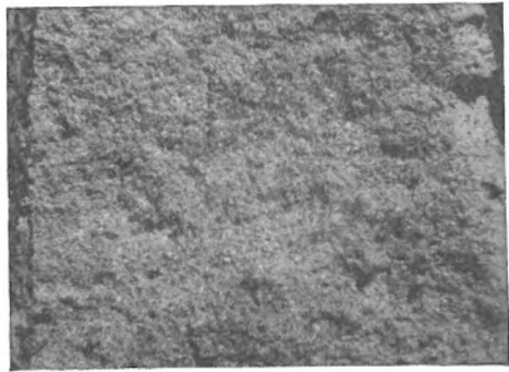
Abb. 54. Graues Roheisen zeigt einen dunklen groben Bruch.
