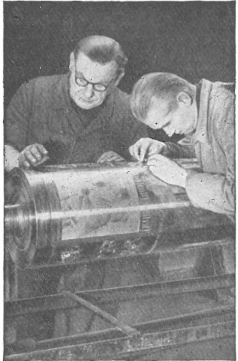
Abb. 40. Nachbearbeitung eines Kupfertiefdruckzylinders. Der Kupferzylinder wird z. B. mit Eisenchlorid oder Salpeter geätzt.
