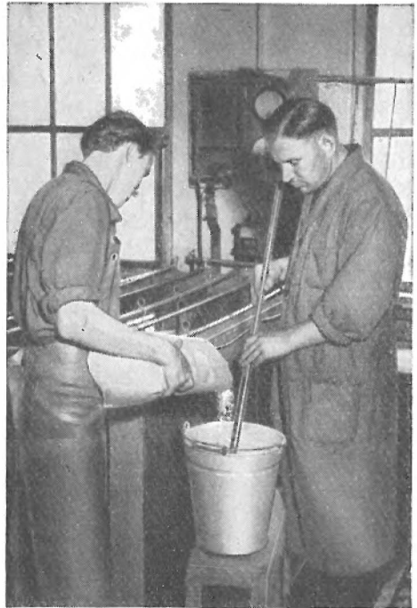
Abb. 29. Nickelsulfat, Nickelchlorid und einige Zusätze werden in Wasser gelöst, um ein galvanisches Nickelbad anzusetzen.
