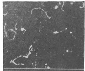
Abb. 121. Die Nebelspuren von \beta -Teilchen sind dünner als die Nebelspuren von \alpha -Teilchen. \beta -Teilchen haben eine größere Reichweite als \alpha -Teilchen.
