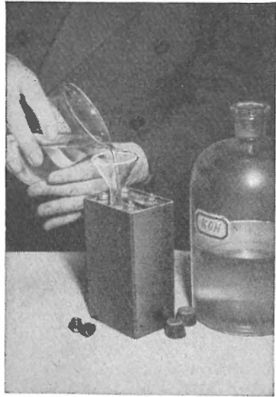
Abb. 33. Der Nickel-Eisen-Akkumulator wird mit Kalilauge gefüllt.
