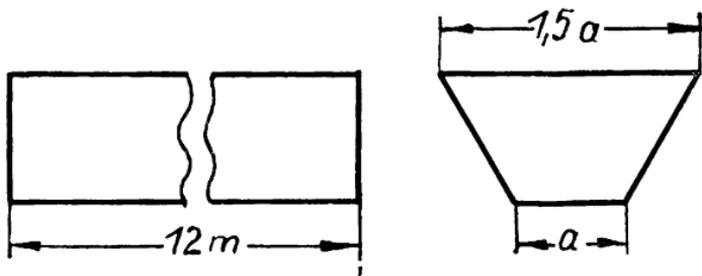
11. In einem Steinkohlenbergwerk soll für einen  $800 \text{ m}$  tiefen Schacht eine Förderanlage gebaut werden. Es sollen Lasten bis zu  $12 \text{ Mp}$  gefördert werden. Das Förderseil besteht aus Stahldrähten und verträgt unter Berücksichtigung der notwendigen Sicherung eine Belastung von  $20 \text{ kp}$  je  $\text{mm}^2$  Querschnitt.
