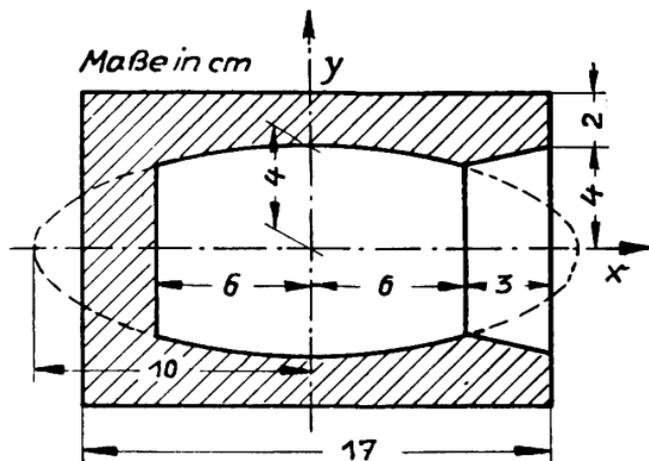
56. Untenstehende Figur zeigt den Achsenschnitt einer Düse.
