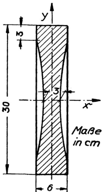
54. Eine Seiltrommel entsteht durch Rotation einer Hyperbel um die  $y$ -Achse (siehe Figur). Sie besteht aus Eisen ( $\gamma = 7,3 \text{ p} \cdot \text{cm}^{-3}$ ).
