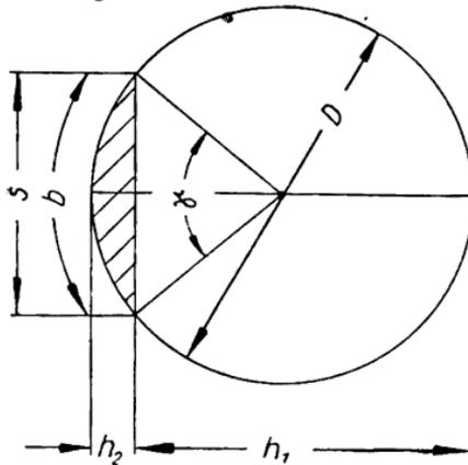
28. Zur Umsetzung von Drehbewegungen in geradlinige Bewegungen gibt es verschiedene Möglichkeiten. Bei Werkzeugmaschinen wird häufig die „schwingende Kurbelschleife“ (Konstruktionsprinzip siehe Figur) angewendet.
