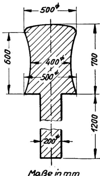
53. Es soll das Gewicht einer eisernen Schwungscheibe ( $\gamma = 7,8 \text{ p} \cdot \text{cm}^{-3}$ ) aus den Maßangaben des untenstehenden Achsenschnittes berechnet werden. Sie wird aus einer zylindrischen Scheibe (Durchmesser  $d = 30 \text{ cm}$ , Dicke  $h = 6 \text{ cm}$ ) durch Ausdrehen der Vertiefungen hergestellt; die gezeichneten Bögen sind Teile einer Hyperbel.
