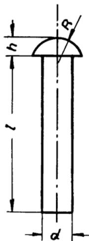
49. Eine Maschinenfabrik fertigt Bolzen, die aus Rundstahl gedreht werden. Die Abmessungen (in Millimeter) sind dem untenstehenden Achsenschnitt zu entnehmen! Berechnen Sie das Gewicht des Bolzens!
