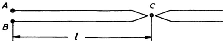
Zur Bestimmung der Schadenstelle C ermittelt man durch mehrere Messungen einen Widerstand von  $R = (13,0 \pm 0,2) \Omega$  in den Leitungsstrecken ACB.
