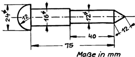
50. Wieviel kp wiegt der in der Zeichnung dargestellte runde Maschinenzapfen aus Stahl? Entnehmen Sie die Maße aus der Skizze! (Wichte des Stahls  $7,8 \text{ p} \cdot \text{cm}^{-3}$ )
