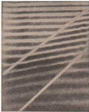
Bild 208. Brechung von Wasserwellen über einer seichten Stelle
