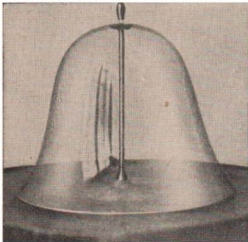
Bild 230. Trifft ein ruhig fließender Wasserstrahl auf einen kleinen Teller, so entsteht eine „Wasserglocke“
