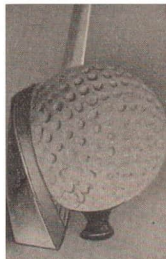
Bild 141. Zeitlupenaufnahme des elastischen Stoßes gegen einen Golfball. Während der Berührungsdauer von \frac{1}{10000} s legen beide Körper gemeinsam 10 mm zurück
