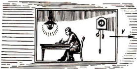
Bild 78. Die gleichförmig geradlinige Bewegung ist in einem allseitig geschlossenen Kasten nicht feststellbar
