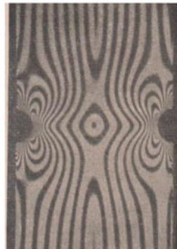
Bild 272. Modell eines mechanisch beanspruchten Werkstückes im Spannungsprüfer
