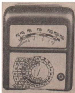
Bild 302. Fotoelektrischer Bellichtungsmesser
