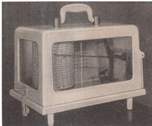
Bild 98. Haarhygrometer mit selbsttätiger Aufzeichnung
