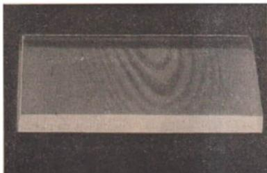
Bild 250. Newtonsche Ringe; eine Spiegelglasplatte liegt nicht genau eben auf einer schwarzen Glasplatte
