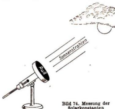
Bild 74. Messung der Solarkonstanten
