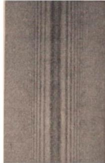
Bild 258. Interferenzstreifen am Schatten eines dünnen Drahtes
