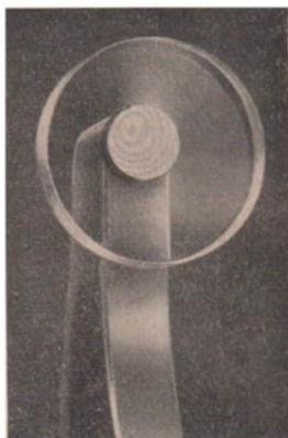
Bild 251. Interferenzen an der Meßfläche einer Feinmeßschraube
