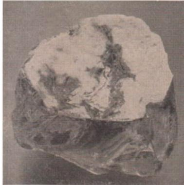
Bild 80. Fehlerhaft erstarrtes Glas (Entglasung)
