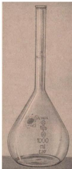
Bild 51. Bei 20°C geeichter Meßkolben mit Ringelmarke und Eichvermerk
