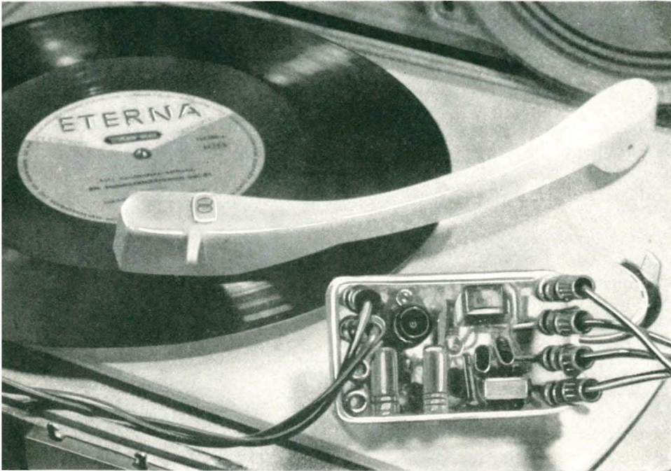
Ein kompletter Transistor-NF-Verstärker nach der Bauanleitung in diesem Buch. Hier zum Abhören von Schallplatten benutzt Der Tonarm gibt einen Größenvergleich (zu Seite 319)
