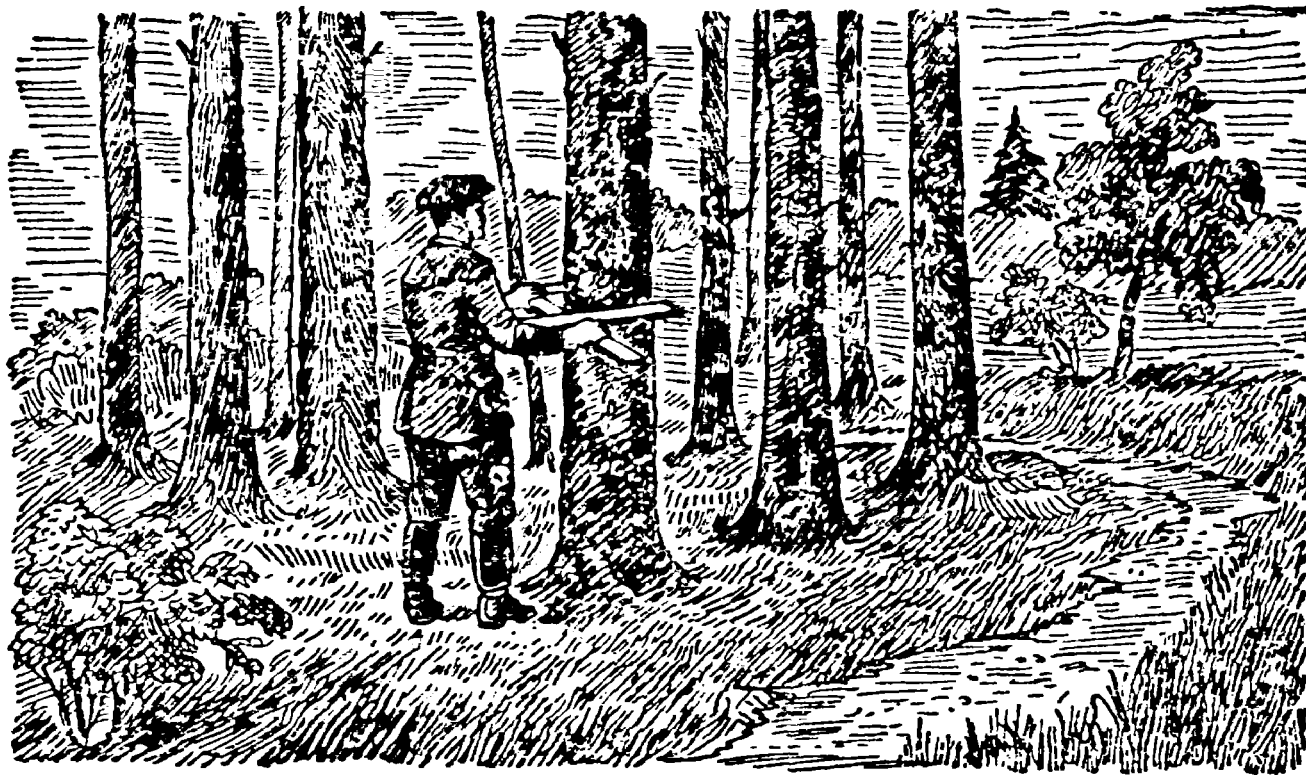
Рис. 19. Измерение диаметра дерева мерной вилкой.
