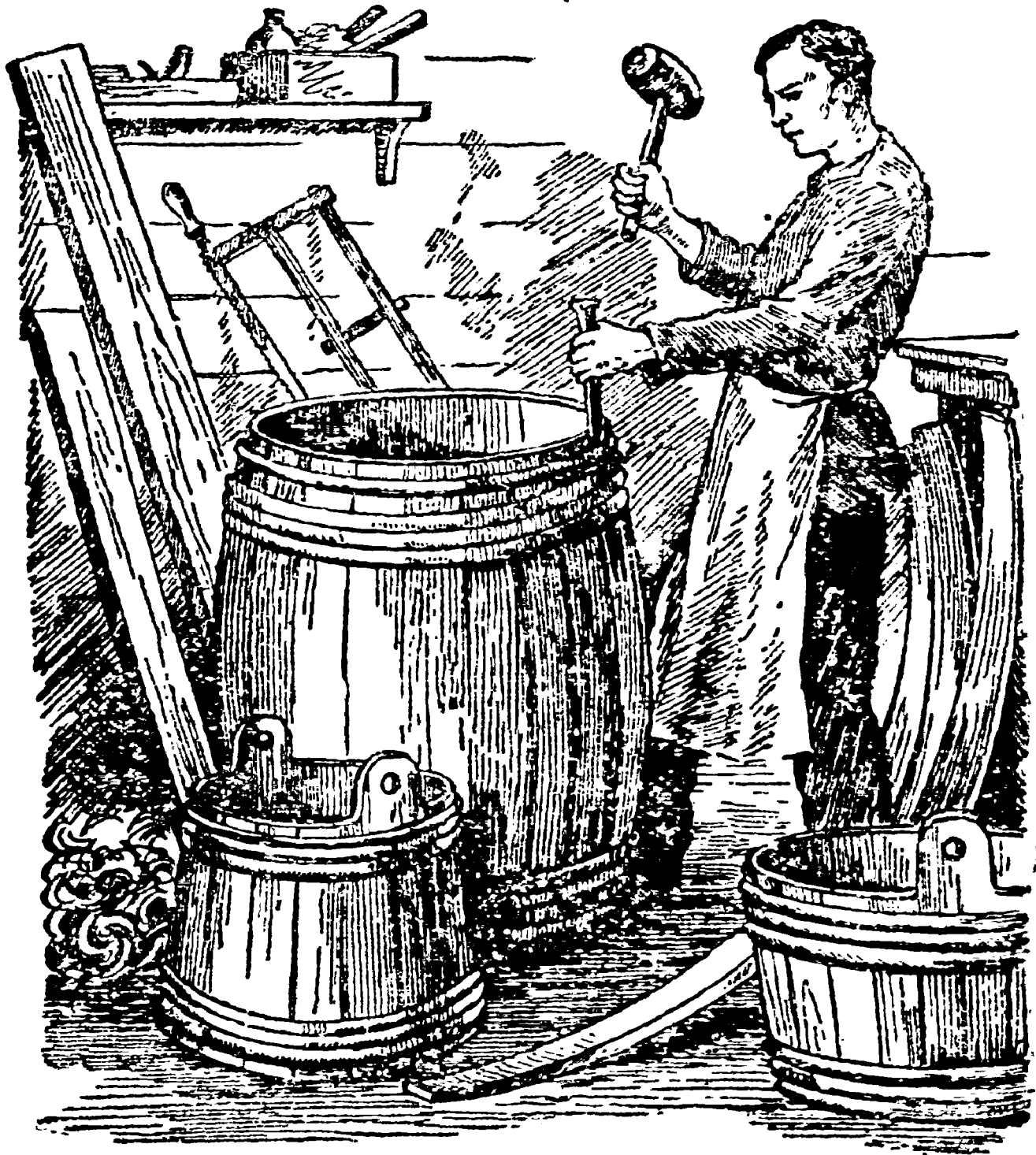
Рис. 110. Тугое обхватывание бочки обручами достигается надвиганием их на широкую часть.
