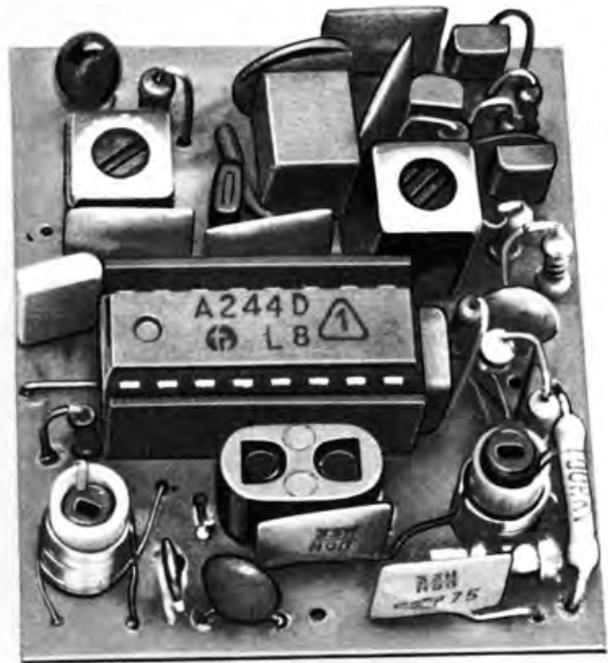
Bild 175. Musteraufbau des IS-Supers in zwei Varianten
