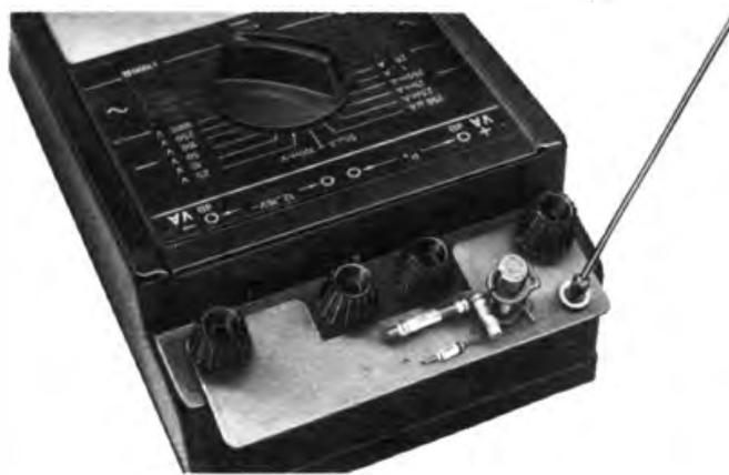
Bild 106. Musteraufbau des HF-Empfängers, am Vielfachmesser montiert
