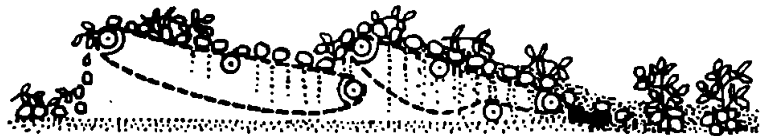
Bild 5 Arbeitsweise des Siebkettenroders
