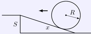
Damit Fässer mit dem Radius  $R$  auf eine Stufe der Höhe  $S$  ( $S < R$ ) ohne stoß gerollt werden können, wird eine rampenförmige Auffahrt gebaut.
