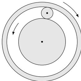
Wenn sich die Kugel des Lagers einmal um ihre Achse dreht, legt sie am Außenring einen Weg von  $5\pi$  mm (ihr Umfang) zurück. Das entspricht  $\frac{1}{6}$  des Umfangs des Außenrings. Zu gleicher Zeit bewegt sie sich auf der Außenfläche des Innenrings  $5\pi$  mm in umgekehrter Richtung. Das entspricht  $\frac{1}{4}$  des Umfangs der Welle. Daraus folgt, dass sich die Achse bei einer Umdrehung der Kugeln um  $\frac{5}{12} = 2,4$  ihres Umfangs dreht.
