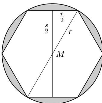
Mit dem Radius  $r$  und der Schlüsselweite 32 mm wird entsprechend der Abbildung
