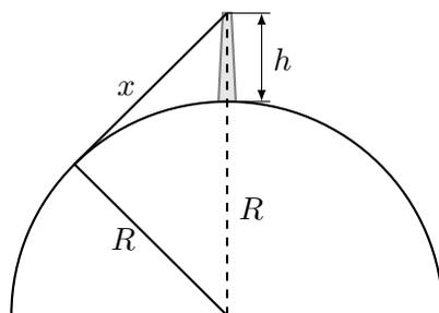
Entsprechend der Abbildung gilt (Turmhöhe  $h$ , Horizontentfernung  $x$ , Erdradius  $R$ )
