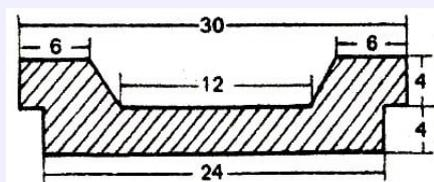
Wie groß ist die Querschnittsfläche des Trägerprofils? Die Maße sind in cm.
