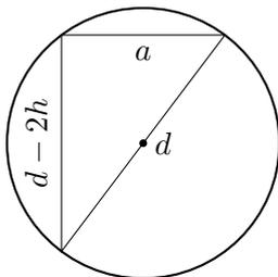
Nach dem Thalesatz kann man ein rechtwinkliges Dreieck in den Kreis einzeichnen. Mit den gegebenen Werten wird für die Hypotenuse des Dreiecks, also den Durchmesser der Trommel
