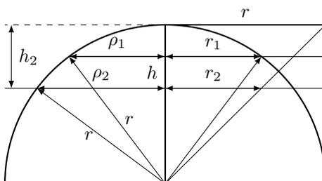
Hat eine Kugelschicht zwischen den Schnittkreisen mit den Radien  $\rho_1$  und  $\rho_2$  die Höhe  $h$ , so ist ihr Volumen nach dem Cavalierischen Prinzip die Differenz eines Zylinders  $\pi r^2 h$  und eines Kegelstumpfes mit den Grundkreisradien  $r_1 = r_2 + h$  und  $r_2$ . Man erhält
