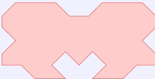
In einer Stanzerei werden aus 8 cm breiten und 16 cm langen Rechteckblechen Formbleche hergestellt, wie sie die Abbildung zeigt. Alle Schnittkanten sind 2 cm lang und verlaufen entweder parallel oder unter  $45^\circ$  zu den Blechkanten. Wieviel Prozent Abfall fällt an?
