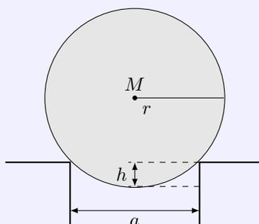
Eine Kugel liegt  $h = 2 \text{ mm}$  tief in einem  $a = 12 \text{ mm}$  breiten Spalt. Welchen Durchmesser hat die Kugel?
