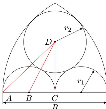
Daraus ergibt sich  $\overline{BC} = r_1 = \frac{R}{4} = \frac{5}{4} = 1,25$  m. Alles eingesetzt wird
