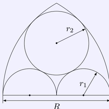
In einem gotischen Bogen sind die Radien  $r_1$  und  $r_2$  zu berechnen, wenn  $R = 5$  m beträgt.
