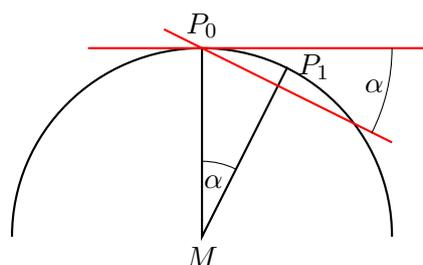
Die Wasserwaage ist dann Tangente an den Kreis. Wenn die Wasserwaage um  $0,5^\circ$  geneigt wird, verschiebt sich der Radius auch um  $0,5^\circ$ , denn Radius und Tangente bilden einen rechten Winkel. Der Berührungspunkt  $P_1$  liegt von Punkt  $P_0$  (Markierung an der Libelle) entfernt:
