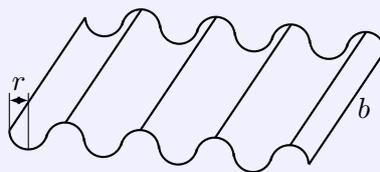
Den Materialverbrauch kontrolliert man, indem man berechnet, wieviel laufende Meter Flachblech derselben Breite wie das Wellblech benötigt werden, um dieselbe Länge (z.B. 100 cm) Wellblech zu produzieren.
