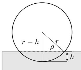
Nach dem Satz des Pythagoras ist  $r^2 = (r - h)^2 + \rho^2$ . Nur die Lösung  $h = r - \sqrt{r^2 - \rho^2}$  ist brauchbar, da bei der zweiten Lösung das Verfahren ( $r = \rho$ ) nicht mehr verwendet werden kann. Für die angegebenen Werte wird  $h = 1$  mm.
