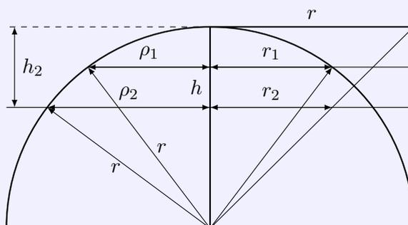
Aus dieser Zeichnung ist die Formel für die Berechnung des Volumens einer Kugelschicht abzuleiten.
