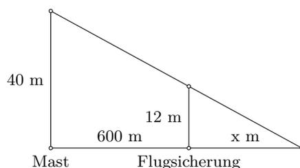
(Abbildung nicht maßstabsgerecht) Die Flugsicherungsanlage wird einen etwa 257 m langen Schatten.
