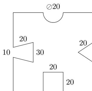
Es genügt, die Querschnitte des Vierkants und der Nuten zu berechnen, da man jeden Rauminhalt des Werkstücks durch Multiplikation mit der Länge erhält.
