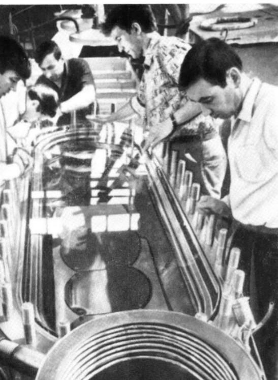
**Blick auf den geöffneten Kammerkörper der 2-m-Wasserstoffblasenkammer. Gebaut im VIK Dubna, arbeitet sie jetzt am Beschleuniger in Serpuchow.**
