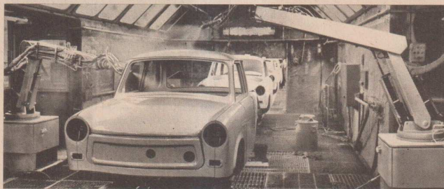
97/3 Beschichten mit Spritzroboter
