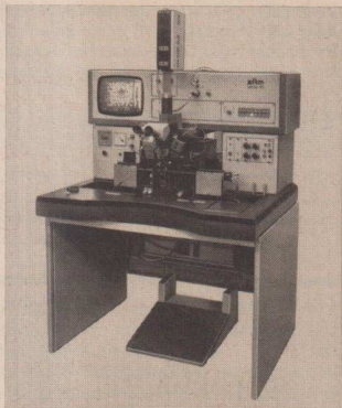
80/2 Numerisch gesteuerter Bonder für die Herstellung integrierter Schaltkreise
