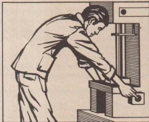
40/1 Bedienen einer Kurbelpresse
