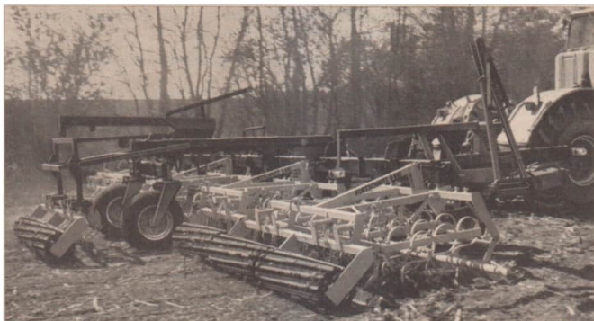
32/1 T 890 mit der Werkzeugfolge: Schleppe – Feingrubber – Schleppe – Winkelstabkrümmer
