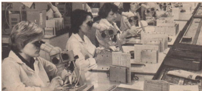
82/1 Kontrolle der produzierten Schaltkreise
