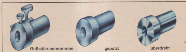
17/2 Gußstück nach Entnahme aus zerstörter Form, nach dem Putzen und dem Bearbeiten
