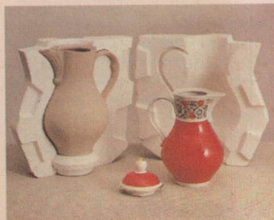
25/2 Gießform, gegossener Rohling und fertige Kanne aus Porzellan
