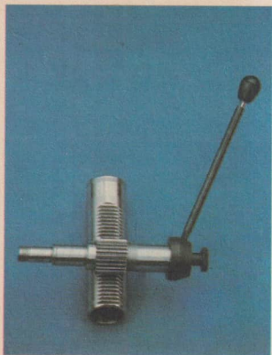
68/1 Vorschubeinrichtung der BT2, links: Gesamtansicht, rechts: Teile (1 Griff, 2 Handhebel, 3 Rändelschraube, 4 Nabe, 5 Vorschubwelle, 6 Spindelhülse)
