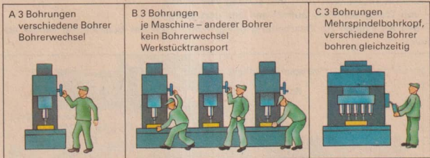
75/1 Gleichzeitiges Arbeiten mehrerer Werkzeuge – weniger Hilfszeit
