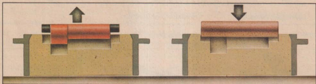
18/3 Entnehmen einer Modellhälfte aus dem Unterkasten, Einlegen des Kerns ②
