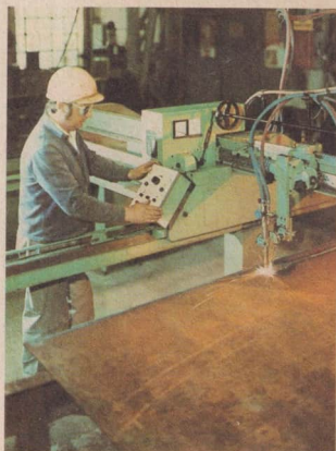
46/2 Arbeiter beim Brennschneiden
