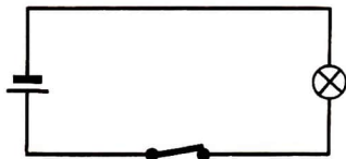
Bild 8 Schaltplan eines geschlossenen Stromkreises
