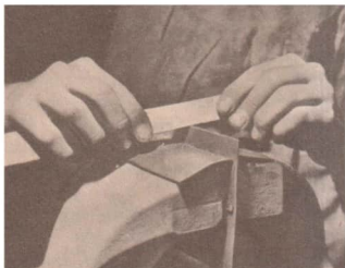
Bild 27 Abziehen von PVC mit einer Ziehklinge
