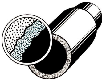
Bild 18 Ölschicht im Lager
