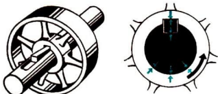
Bild 5 Befestigung durch Keil
