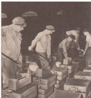
Bild 5 Gießen von flüssigem Grauguß in Sandformen
