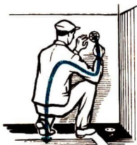
Bild 1 Der Strom fließt durch den Körper
