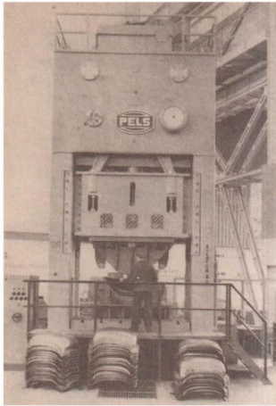
Bild 54 Tiefziehen von Blechteilen an einer Kniehebel-Ziehpresse
