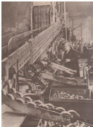
Bild 3 Massenfertigung von Kugellagern
