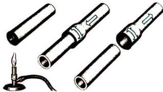
Bild 15 Anfertigen einer Rohrmuffe
