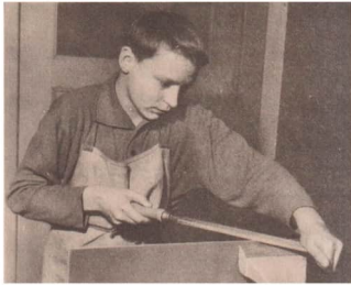
Bild 25 Feilen von PVC. Die Feste wird schrag angesetzt
