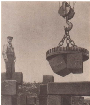
Bild 14 Elektromagnet beim Verladen von Stahlblöcken
