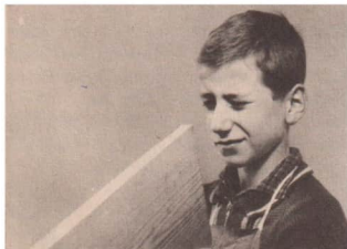
Bild 1 Der Tischler fluchtet über eine Kante
