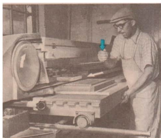
Bild 28 In den Produktionsbetrieben werden schnelllaufende Bandschleifmaschinen eingesetzt
