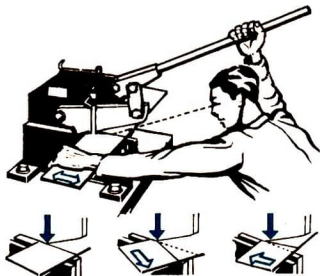
Bild 20 Scheren an der Handhebelschere
