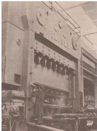
Bild 58 Stufen-Umformautomat zum Tiefziehen vom VEB Pressen- und Scherenbau Erfurt. Die Maschine hat eine Masse von 250 t
