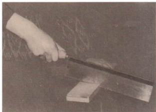
Bild 13 Das Ansägen erfolgt über die Kante des Holzes
