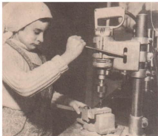
Bild 38 Bohren an der Tischbohrmaschine
