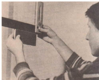
Bild 7 Prüfen eines Werkstückes nach dem Lichtspaltverfahren
