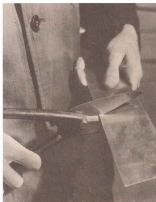
Bild 16 Scheren mit der Handblechschere
