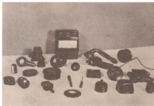
Bild 3 Gegenstände aus Duroplast
