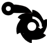
Bild 17 Sperrrad mit Sperrklinke verhindert das Zurückdrehen
