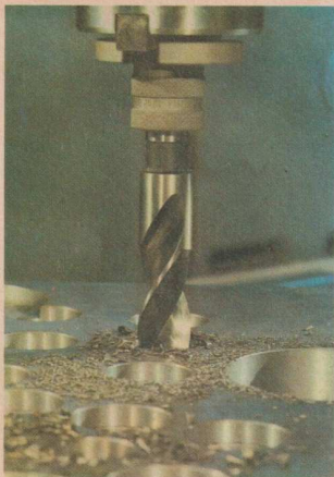
11/1 Arbeitsorgan einer Bohrmaschine mit Spanneinrichtung
