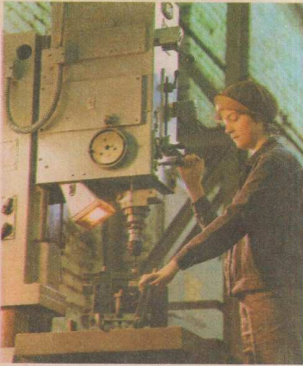
9/1 Bedienen einer Säulenbohrmaschine; Spanneinrichtungen halten Bohrer und Werkstück in Funktionslage
