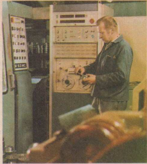
7/1 Steuerorgan einer Drehmaschine
