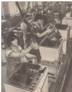
8/1 Montagearbeitsplätze am Endmontageband des Waschautomaten A 55
