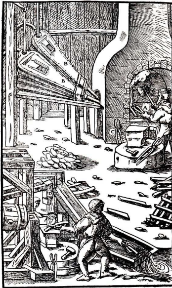
Mittelalterlicher Schmiedehofen, mittels Blasebälgen betrieben (aus G. Agricola, „De Re Metallica“)
