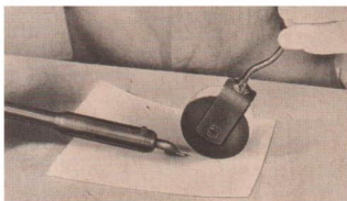
Bild 91/3 Schweißen durch Berührungswärme
