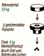
Bild 81/1 Werkstoffeinsparung an einem durch Umformen hergestellten Flansch
