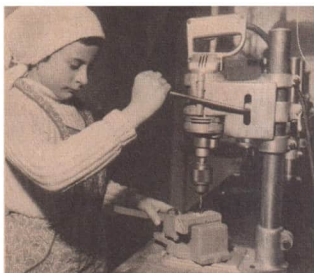
Bild 52/1 Arbeiten an der elektrischen Handbohrmaschine mit Ständer
