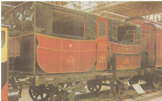
Britischer Postwagen von 1838 mit abklappbarem Netz zur Postaufnahme während der Fahrt
