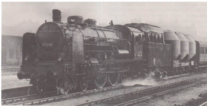
Kohlenstaublikomotive der Deutschen Reichsbahn – hinter dem Tender ein zusätzlicher Behälterwagen für Kohlenstaub
