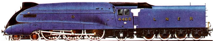
Expreß-Züge der britischen „London-North-East-Railway“ (London-Nord-Ost-Eisenbahn) wurden zwischen 1934 und etwa 1955 von diesen stromlinienförmig verkleideten großen Pacific-Schnellfahrlokomotiven gezogen
