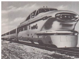
Leichtmetall-Dieseltriebzug der nordamerikanischen Eisenbahnen von 1955 – ein „Aerotrain“
