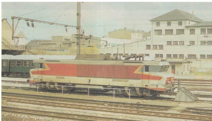
Moderne französische Elektrolokomotive vom Typ CC 2100 für unterschiedliche Stromsysteme zur Beförderung von Expreßzügen; mit ihren 5780 kW erreicht sie 220 km/h
