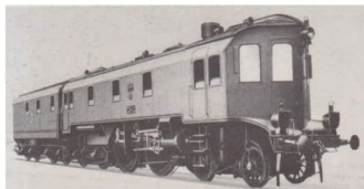
Für Schnellfahrlokomotiven erprobte man windschnittige Bauformen wie an dieser Dampflokomotive mit vom liegendem Führerstand der Bauart Kuhn-Wittfeld von 1904
