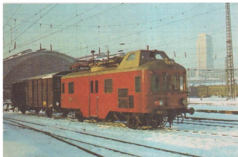
Tragwerk und Fahrleitungen elektrifizierter Strecken bedürfen ständiger Kontrolle und Wartung, dazu dienen Fahrleitungs-Revisionswagen
