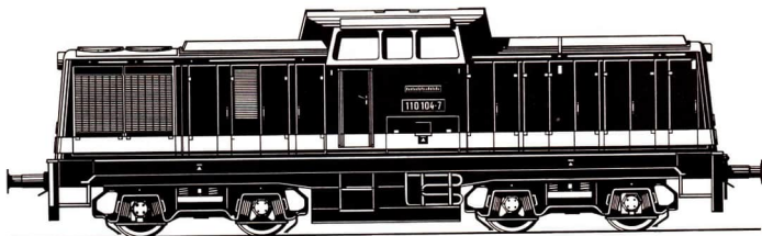
Diesellokomotive mit hydraulischer Kraftübertragung der Baureihe 110 der Deutschen Reichsbahn für Personen- und Güterzugverkehr
