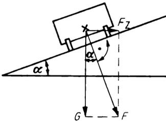
3. (Bild 46) Die resultierende Kraft aus Fliehkraft und Gewichtskraft muß senkrecht durch die Fahrbahn gehen wie bei Geradeausfahrt die Gewichtskraft. Daraus folgt der Ansatz für  $\tan \alpha$ .
