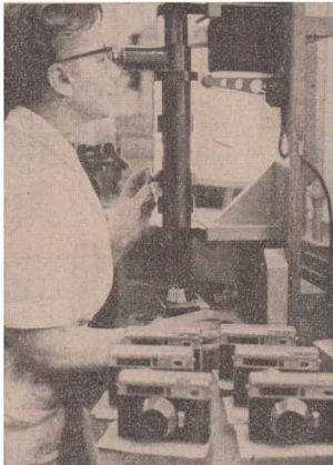
85/1 Prüfen der Optischärfe bei Kameras
