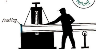
13/2 Anschlag an der Kreissäge erübrigt das wiederholte Messen
