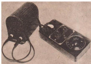
26/1 Messen eines Widerstandes mit einer Meßbrücke
