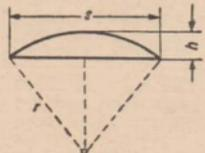
Welcher Halbmesser  $r$  gehört zu einem Segmentbogen von der Spannweite  $s = 5,35$  m und der Bogenhöhe  $h = 0,50$  m?
