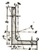
Werkstoff: Flußstahl ( $\gamma = 7,85 \text{ kp/dm}^3$ )  $r_1 = r_2$  (auf halbe mm gerundet)
