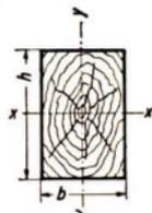
Das Gewicht ist für halbtrockenes Kiefernholz mit  $\gamma = 650 \text{ kp/m}^3$  berechnet.
