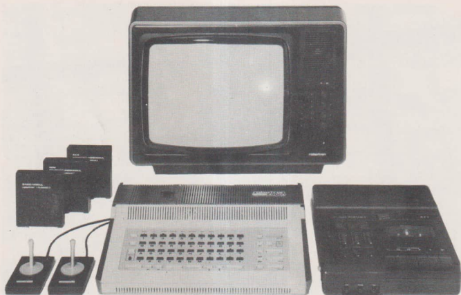
Bild 7. Mikrocomputer Z 9001 mit Zubehör: Farbfernsehgerät, Kassettenrecorder, BASIC-Modul, ROM und RAM Zusatzspeicher und Steuerhebel (mit Genehmigung des Herstellers VEB Robotron MeBelektronik „Otto Schön“ Dresden, Bildautor Foto-Darre Dresden)
