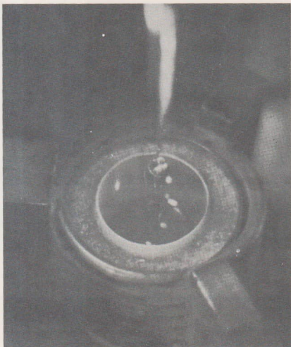
Bild 1. Ziehen eines Einkristalls aus der Schmelze nach CZOCHRAL- SKI [ADN-ZB/Kürsten]
