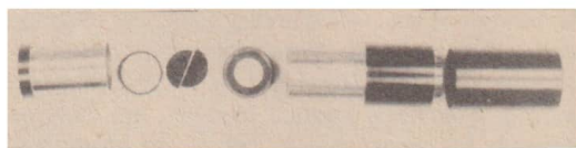
Bild 1: Anordnung Spalt – Okular – Okularspektroskop in Einzelteilen
