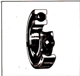
Bild 12/2 Punkt- bzw. linienförmige Auflage bei unterschiedlichen Wälzkörpern
