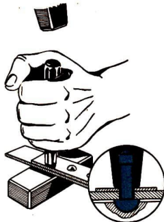
44 Einziehen mit dem Nietenzieher
