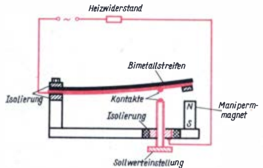
Bild 281. Zweipunktregler mit Bimetallschalter
