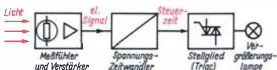
Bild 170. Blockschaltbild einer Belichtungszeitsteuerung
