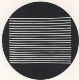
Bild 295 Oszillogramm eines Rasters mit 20 Zeilen und dunkelgetastetem Bildrücklauf
