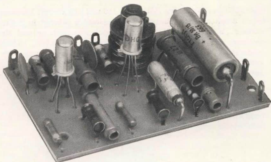
Bild 273 So sieht die bestückte Leiterplatte des Transistor-Zweikreis- aus
