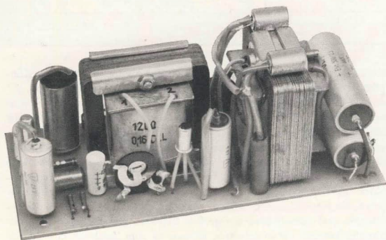
Bild 268 So sieht die bestückte Leiterplatte des Gegentaktverstärkers aus
