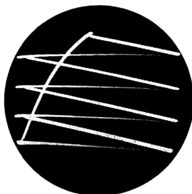
Bild 294 Oszillogramm eines Rasters mit 4 Zeilen
