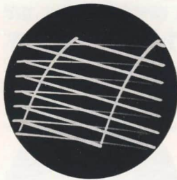
Bild 298 Oszillogramm eines Rasters mit Zeilen- sprung
