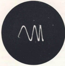
Bild 104 Oszillogramm einer Wechselspannung
