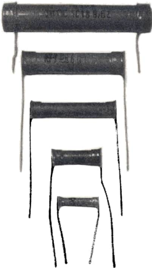
Schichtwiderstände unterschiedlicher Belastbarkeit
