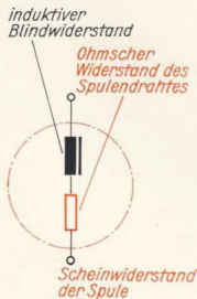
Bild 45 So müssen wir uns die Scheinwiderstände von Spule und Kondensator „zusammengesetzt“ vorstellen
